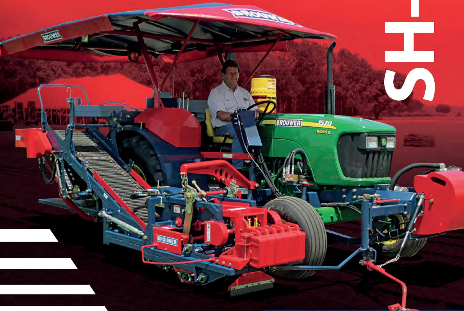
HAND STACK SOD HARVESTER
